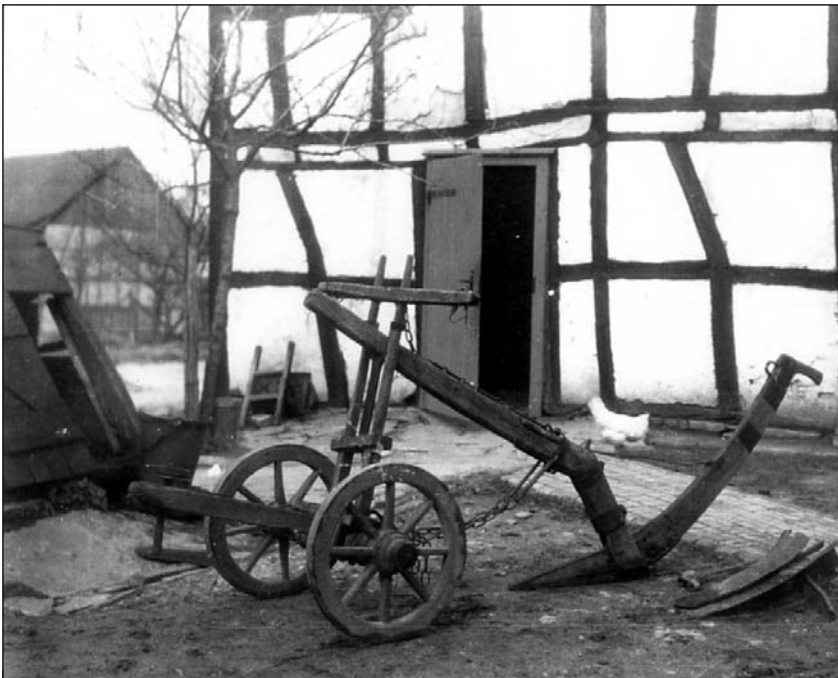
Auf einem kleinen Bauernhof: Der Hakenpflug »Hongsploch« wurde oft von einer Kuh gezogen; links der geöffnete »Pütz«. (2)
